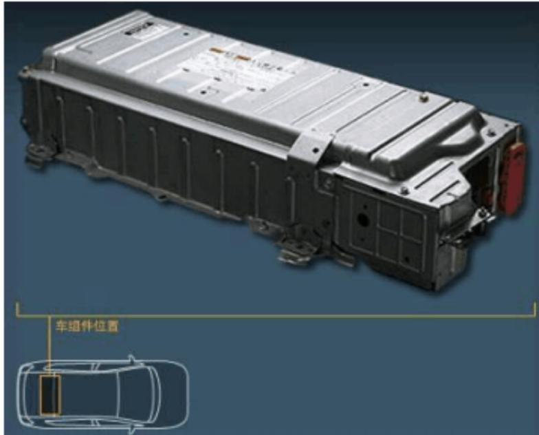
由 28 个 6.9V 镍氢单体电池组成的，电压为 274V ，在升压器的作用下电压可以提升至 500V ，更高的电压有利于提高效率。它同时装有汽油发动机和电动机两套系统。启动、加速和上坡时两套系统同时出力；刹车时能量逆向存入蓄电池；平稳行驶时，由蓄电池驱使电动机单独出力，不再烧油。算总账，混合动力车可以节省一半汽油，尾气污染自然也减少一半。现一汽丰田 国产 PRIUS 已下线。
