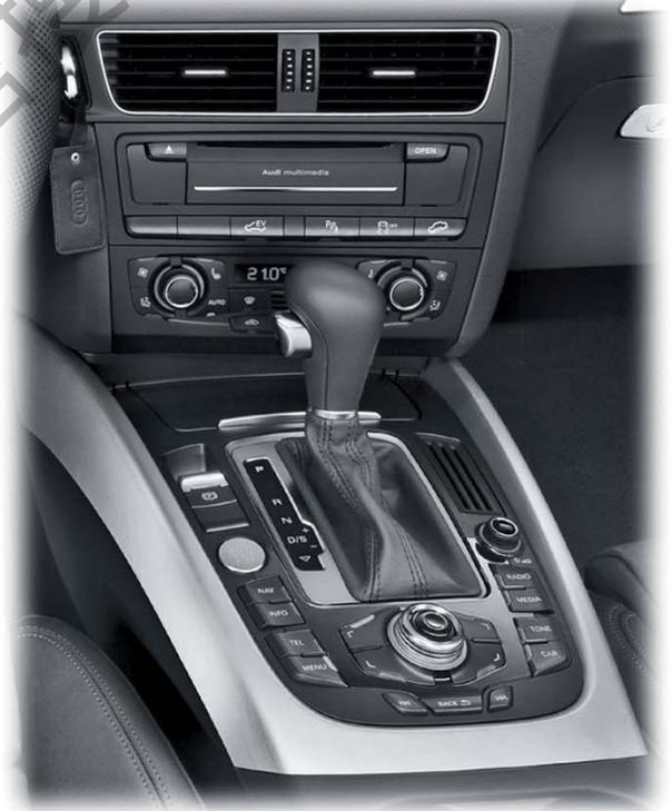
EV-模式开关和带有tip-S 功能的换挡操纵机构
