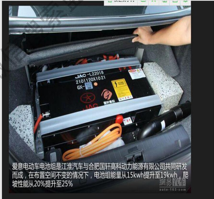
爱意电动车电池组是江淮汽车与合肥国轩高科动力能源有限公司共同研发而成，在布置空间不变的情况下，电池组能量从15kwh提升至19kwh，爬坡性能从20%提升至25%
