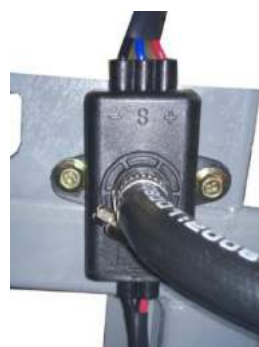
真空泵控制器
