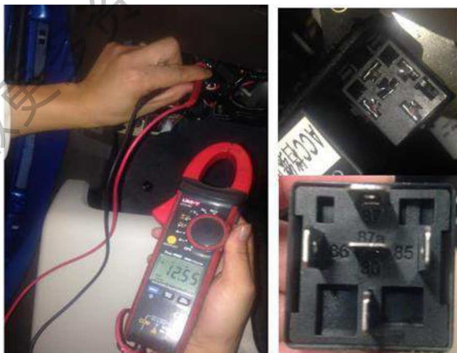
图 4.9 整车五脚继电器接口
