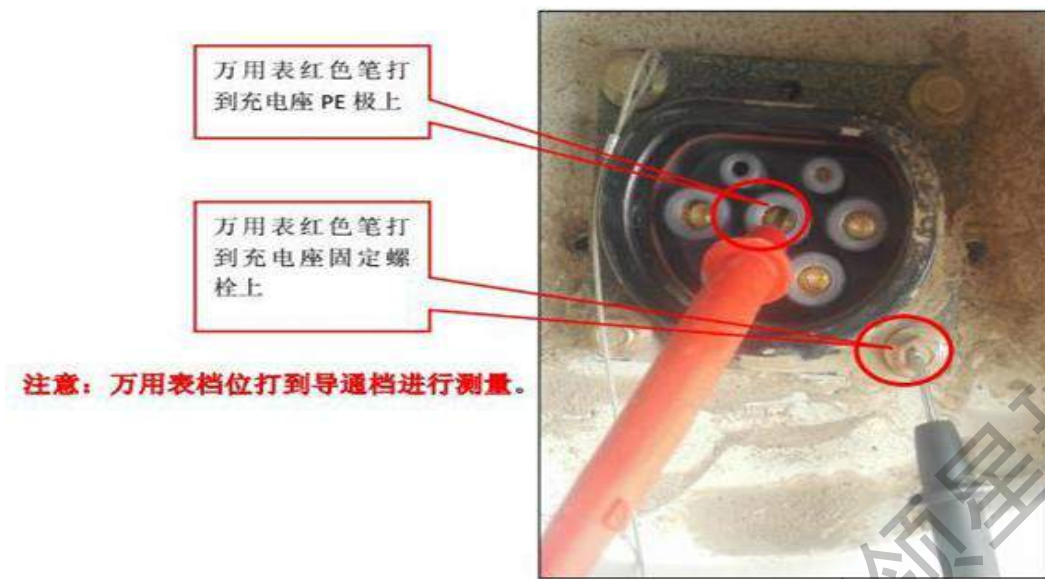
图 4.11 测量接地导通示意图
