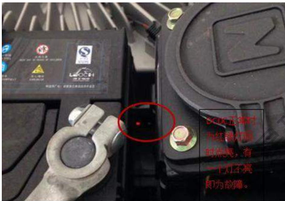
图 4.8 充电一体机 DCDC 指示灯示意图
