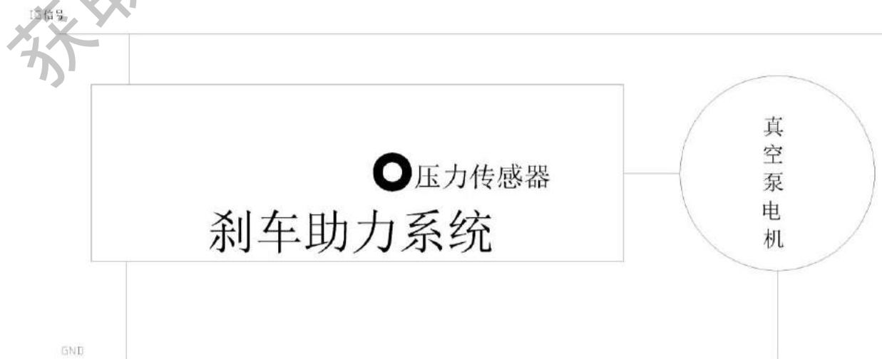
图 10.3 真空助力系统原理图
