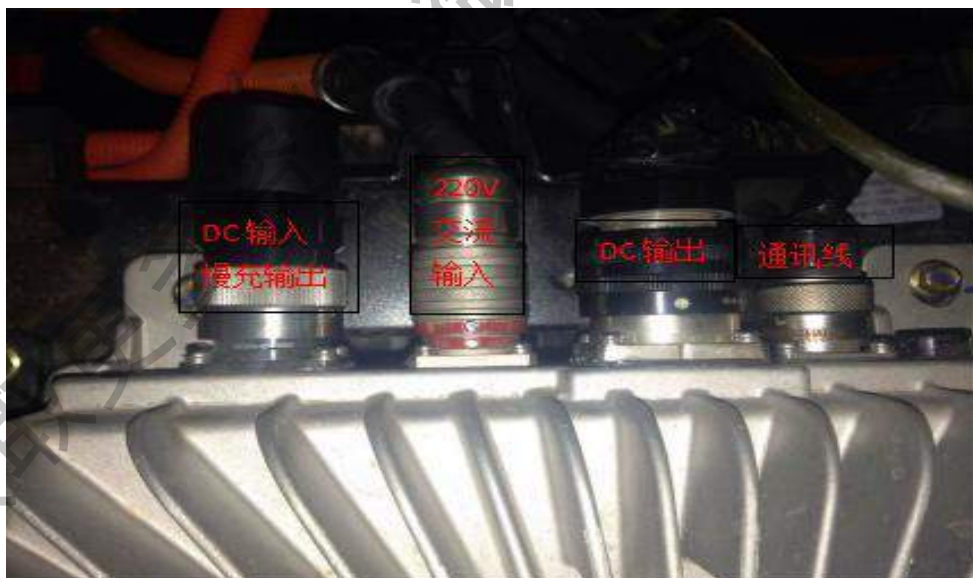
图 4.12 一体机线束接口示意图
