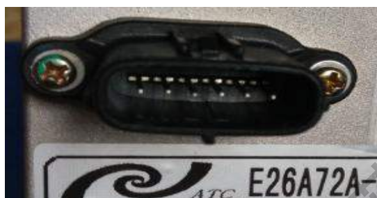
图 9.5 空调压缩机一体化控制器插头
