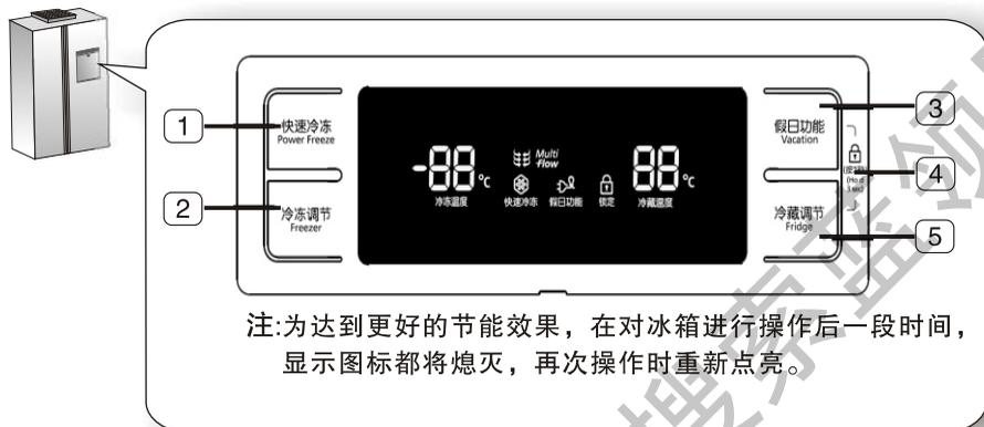
注:为达到更好的节能效果,在对冰箱进行操作后一段时间,显示图标都将熄灭,再次操作时重新点亮。
