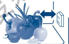
在冷藏室内如图所示的位置，有温度感知器件。请务必保证该器件不要被食品完全堵住，否则有可能造成冰箱测量不到正确的温度而间歇地工作，导致冰箱冷藏室温度过低，同时还浪费了不必要的电能。
