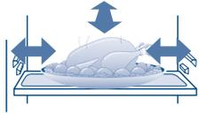
冰箱内存放食品特别是油类食品与内胆长时间接触，会造成内胆腐蚀，应尽量避免食品与内胆直接接触，当内胆沾上油污时，应及时清理干净。
