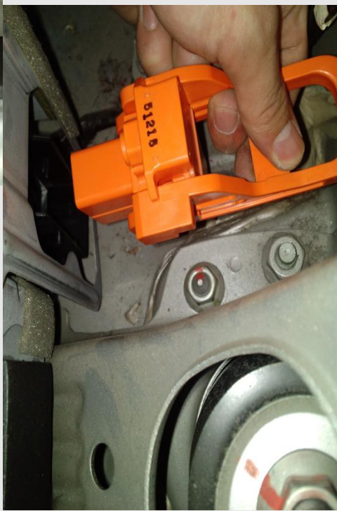
图四如图示 拆下检修塞
