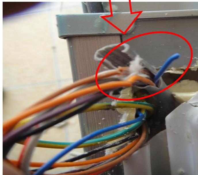
5.使用电烙铁将导线断裂部分焊接，并用绝缘胶带妥善包裹，之后用力将导线抽出即可。
