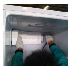
拆除冷藏门道上图中的两颗螺钉即可取下冷藏风道盖板。
