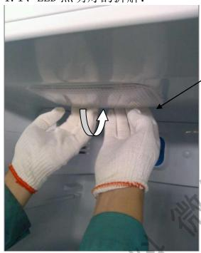
双手扣住 LED 灯的内侧,向下用力,即可扣出 LED 灯的灯罩。
