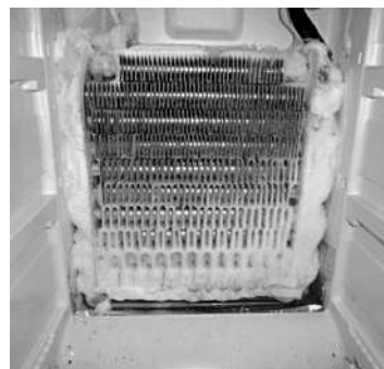
图2 接通加热器前蒸发器上结霜情况
