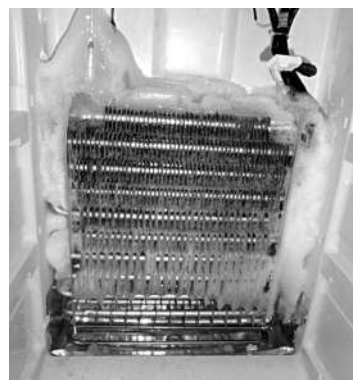
图3 接通加热器后第二次化霜效果
