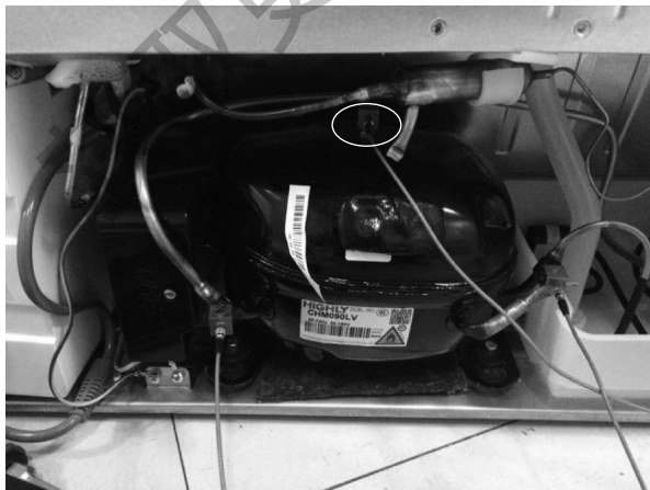
图 1 冰箱压缩机激励测试
