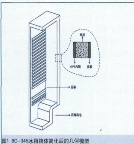
图1 BC-345冰箱箱体简化后的几何模型
