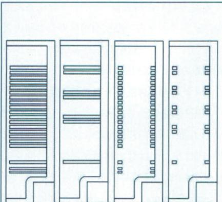
图5 箱体截面显示的层条分布方案（左边两个为连续层条，右边两个为间断层条）
