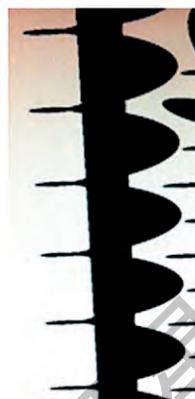
图2 旋翅冷凝器局部放大图
