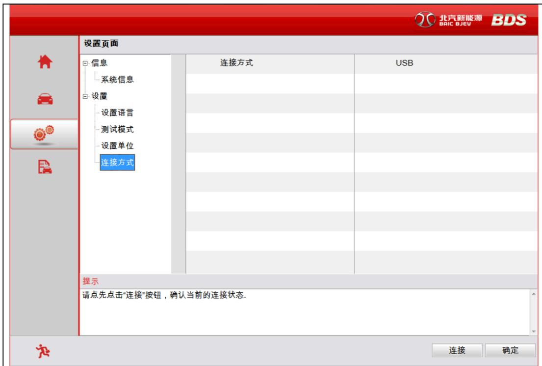
注：激活和软件升级时，需 USB 连接模式下进行，诊断车辆时，WIFI 和 USB 两种模式均可以进行。
