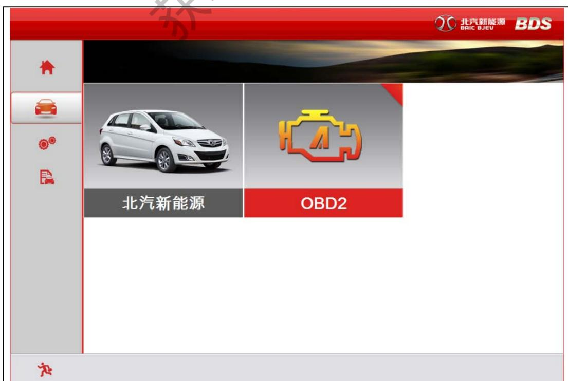
选择你需要的车型图标，点击软件版本，进入对应车型诊断程序。如下图所示：
