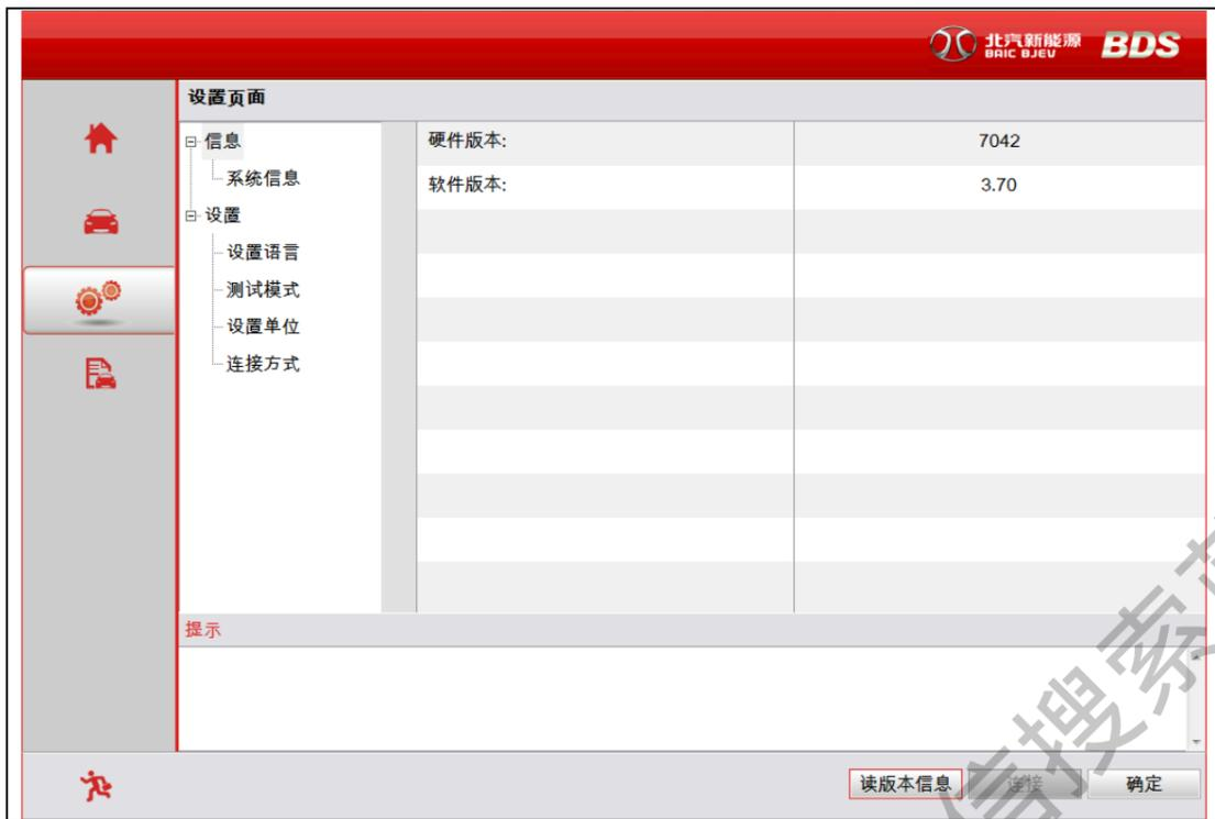
注：USB 正常时可以读到 BDS 的软、硬版本信息。也可以选择连接方式查看 BDS 处于哪一种连接方式，如下图：
