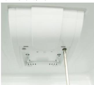
3. 取下灯盒，用螺丝刀卸下固定 LED 灯的螺钉。
