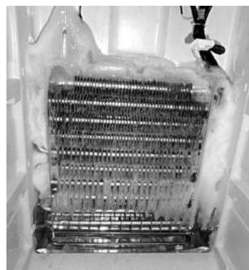
图3 接通加热器后第二次化霜效果
