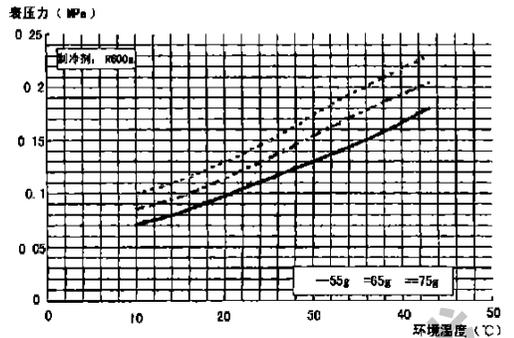
图 7 BCD-241/HC 制冷系统压力与环境温度曲线
