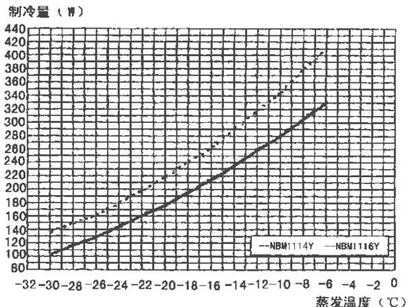
图 1 不同排气量压缩机制冷量对比曲线
