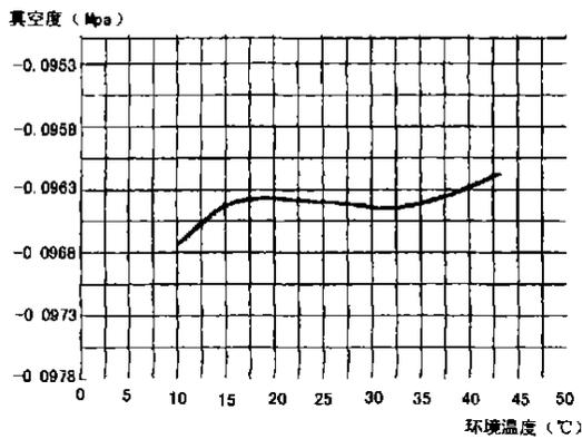
图 6 BCD-241B/BC 蒸发表压力与环境温度
