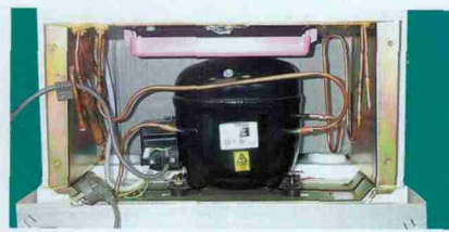
图5 压缩机在拔管塞后焊入制冷系统前暴露在空气中时间不应超过5分钟
