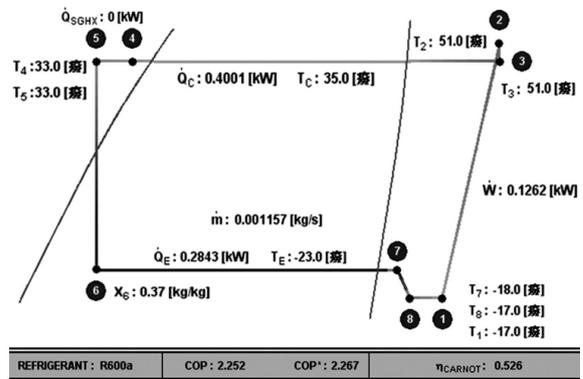
图 4 冰箱工况下的制冷循环图
