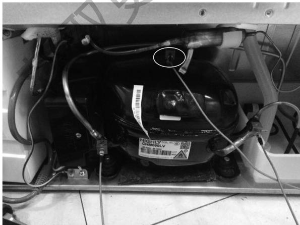
图 1 冰箱压缩机激励测试
