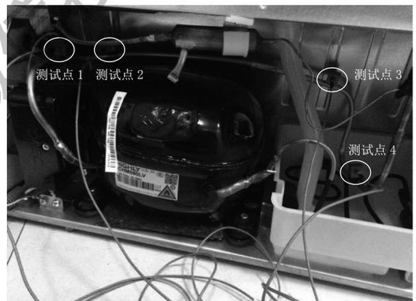
图 3 回气管振动测点布置
