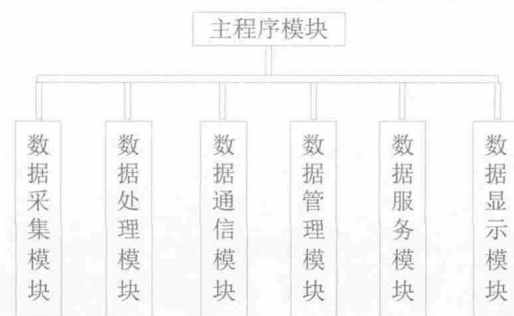
图 2 上位机软件结构图
