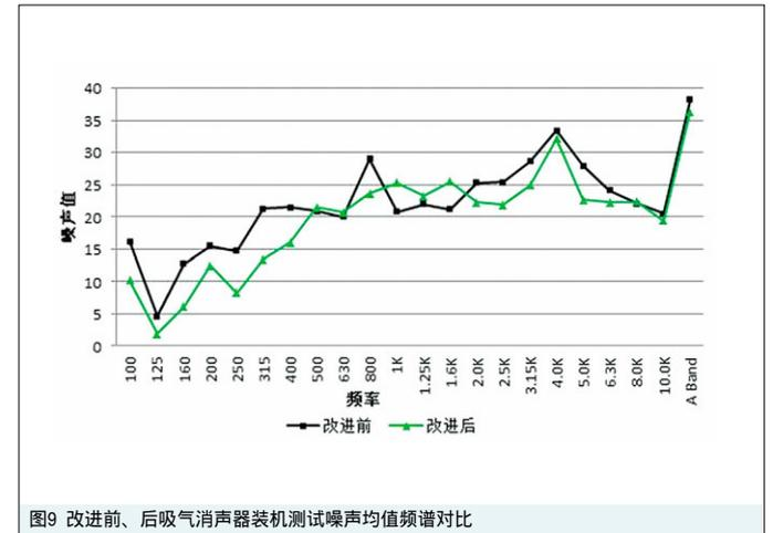
图9 改进前、后吸气消声器装机测试噪声均值频谱对比
