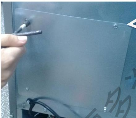
使用 M6 套筒将位于冰箱后背的主控板、电源板四个螺钉拆下，取下金属盖。
