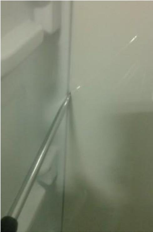
注意：冷冻室的下风道盖板拆解过程中容易造成卡扣的断裂，技师在拆解的时候应缓慢用力，防止卡扣断裂之后影响风道密封效果！
