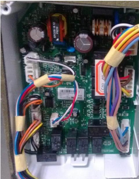
用手按住主控板底部的卡扣，轻轻的向下用力，即可取出触控板。
