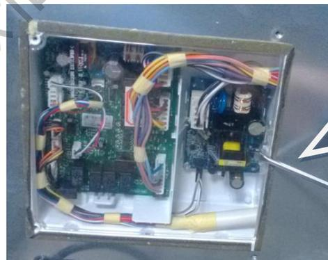
使用一字螺丝刀插入透明罩盖边缘，向外轻轻撬起，即可取下透明罩盖。
