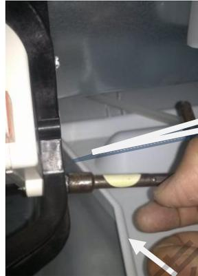
使用 M6 的套筒拆除两个螺钉。
