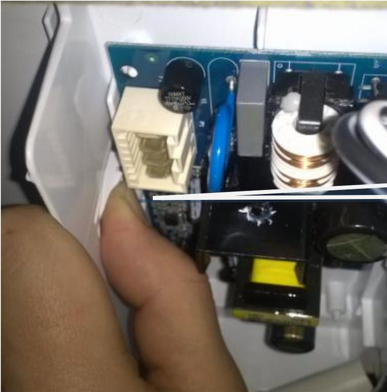
用手按住电源板左侧的卡扣，即可取下电源板。
