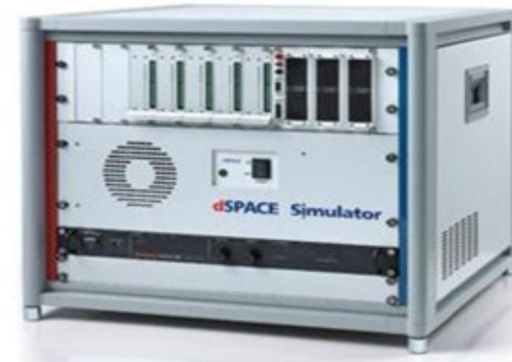
采用实际零件和仿真模型相结合
