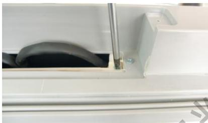
3. 取出显示器支撑件，并拔下连接线。
