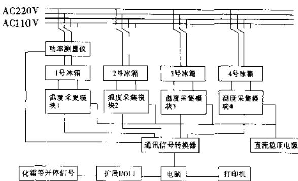
图1 硬件系统流程图
