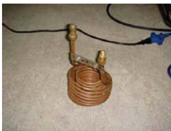
冷却盘管 (将盘管浸入水中进行冷却)
