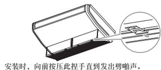
2. 按压吸气格栅, 按一下过滤网将其从凸起上拆下并向下拉动。
