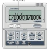
发生任何事件时空调器将停止。同时，检查指示灯闪烁红色且错误代码显示在开机定时器显示区域，下列信息显示在显示区域。
