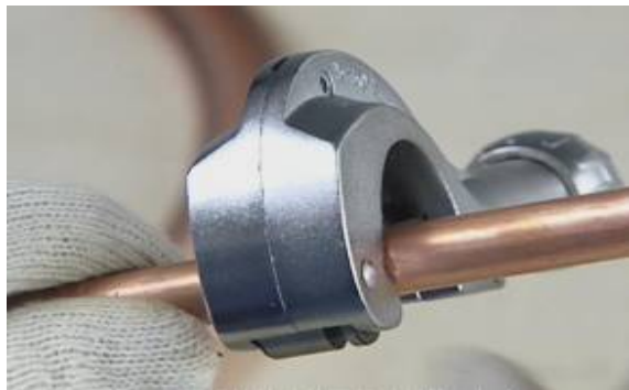
使用割管器进行切割铜管，不易产生毛刺
