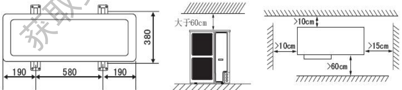
室外机安装尺寸 (mm)
