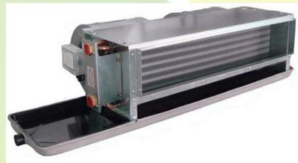
**特点:** 空调通过冷媒的蒸发（或冷凝）制取冷（热）水后通过水管输送到每个房间的风机盘管后跟室内空气换热，水循环动力来自水泵，有水冷和风冷两种形式。
