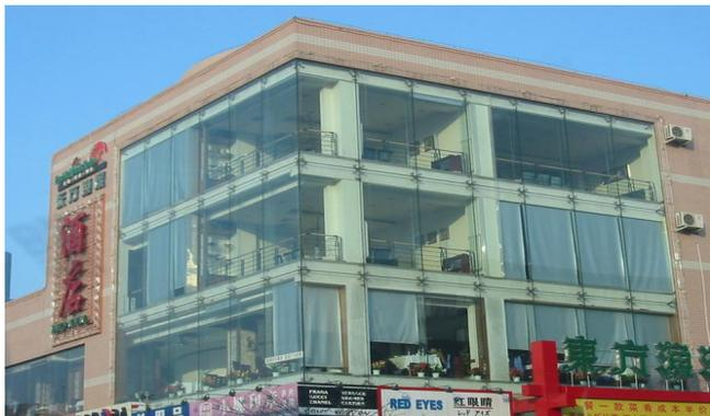
**大面积的玻璃幕墙**传热量会非常大，因此在遇到玻璃幕墙做围护结构的工程,需要在当地基准负荷指标进行放大，正向修正30%~50%，甚至更高，建议精确核算。
