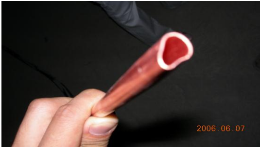
使用的铜管管壁厚度不够，施工时容易变形，承受不了系统压力（差）
