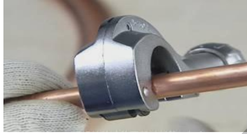
使用的专用的工具切割铜管（正确）
