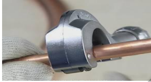
使用的专用的工具切割铜管（正确）
