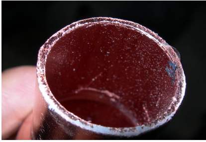
铜管使用钢锯切割，导致管内有大量铜屑，管口不平整（错误）
