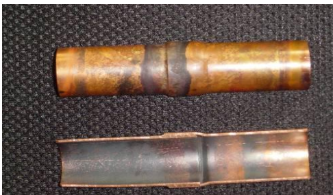
管路焊接时没有充氮气保护，铜管内壁产生大量的氧化皮（差）
