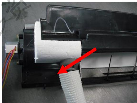
锁合圈（箭头部位）已裂烂，若强行装配，将导致出水嘴部位渗水
