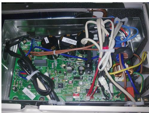
图(10)变频外机电控布线
