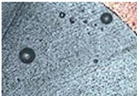
图3-9 焊缝表面上钎料内部气孔
