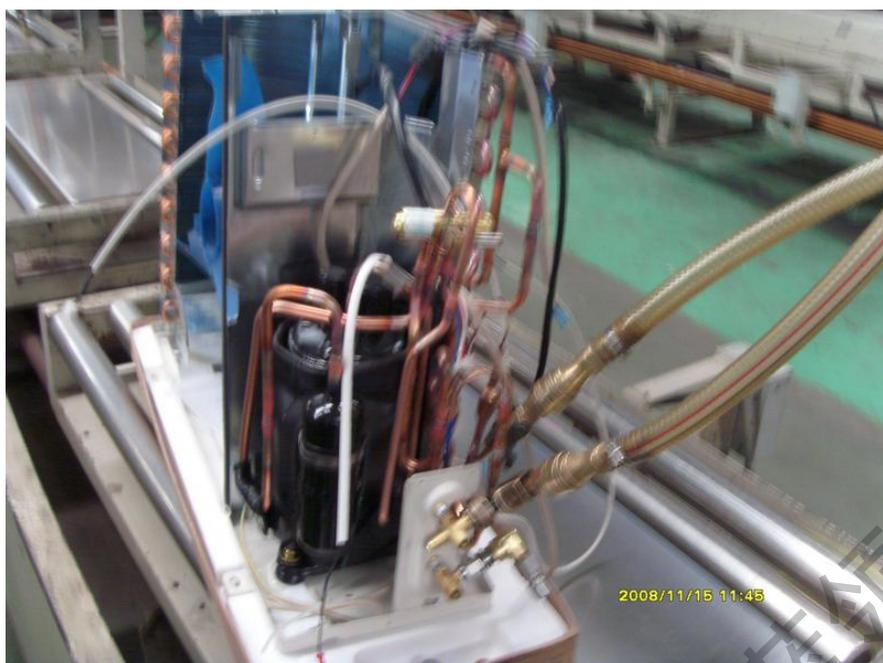
为使制冷系统内真空度及压力回升值满足要求，真空泵的抽真空速度设定  $16.5\text{m}^3/\text{h}$ （分体机和窗机）或  $25.7\text{m}^3/\text{h}$ （柜机），生产不同机型时，调节生产线节拍，都应使空调器在抽真空环形线上运行一周的时间控制在 5 分钟以上
