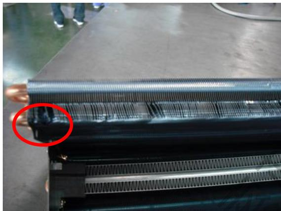
图示部位蒸发器因出风框装配不当造成严重片花
