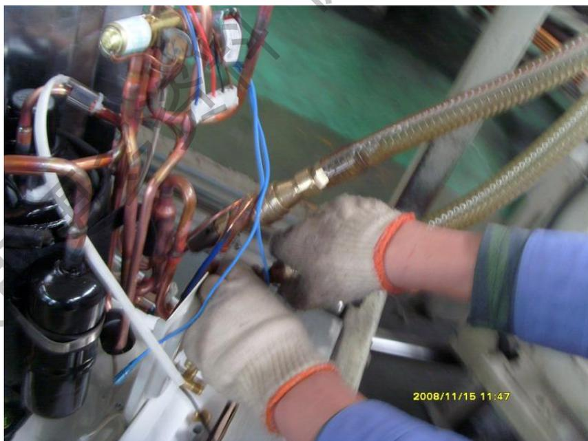
当空调器运行到达抽真空环行线出口处的倒数第二个小车时，且真空度达到要求（真空表显示系统真空度 $<20\text{Pa}$ ）（待完善）后：
