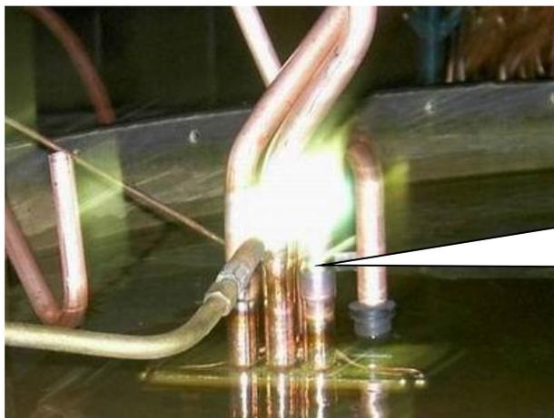
拆装四通阀时应将四通阀浸在水中焊接，水面高于阀体10~20mm
