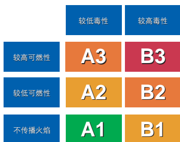
图1-2-1 制冷剂的安全分类（ASHRAE）
