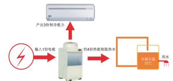
综合能效比=输出能量÷输入能量=(制冷量+制热量)÷输入功率
