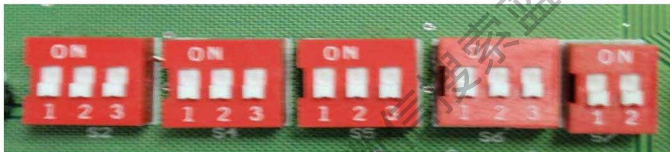
拨码S2的定义，相对最高环境温度进入静音模式间隔时间和静音模式持续时间。
