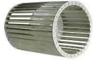
机组的送风量和换热效果。符合空气动力学的蜗壳板，防止在出口气流中形成涡旋，叶轮采用优质板材经精密级进口模冲压、卷边成型，确保风机的气动性能达到最佳状态，轴套经压铸后高精度加工而成，轴孔公差、垂直度、同轴度偏差均 $\leq 0.01\text{mm}$ 。风机 100%经过严格的动平衡调校，确保机组运转更加宁静、平稳。风机 100%经过严格的动平衡调校，确保机组运转更加宁静、平稳。
