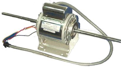
采用单相电容运转式电机，三速控制；进口品牌高精度、低噪声轴承，密封润滑，无需加油；中心轴经表面防腐蚀处理，经久耐用；电机防护等级为 IP20 级，绝缘等级 B 级，安全性更高；电容外包金属外罩，外露电线均有金属软管，符合保护要求，可
