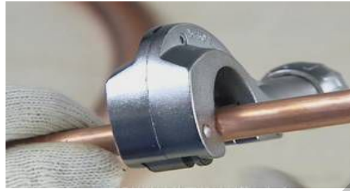
使用的专用的工具切割铜管（正确）
