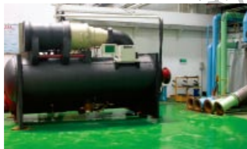
中国首家通过AHRI认证的水冷机组测试台(武汉) 国家级精密消声测试室(深圳)
