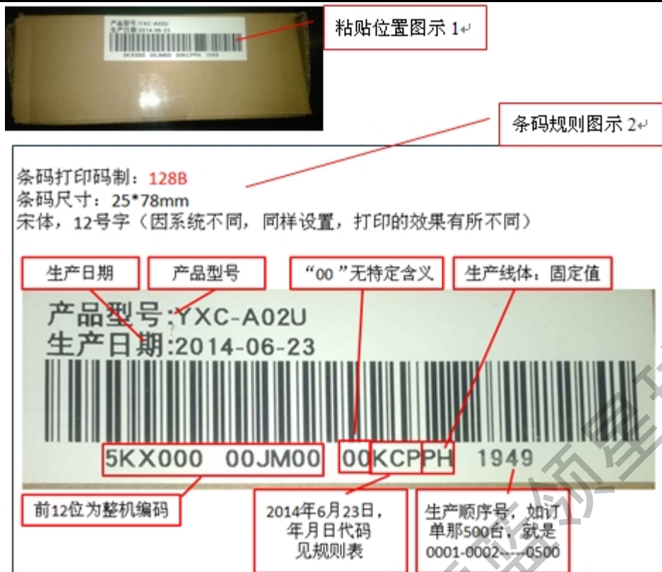
图7 生产条码样式及粘贴
