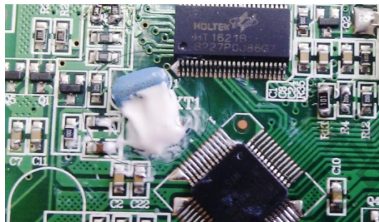
图 1 陶振用 708 硅胶固定
