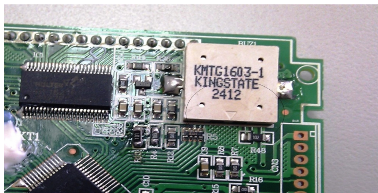
图 6 蜂鸣器音孔方向一致
