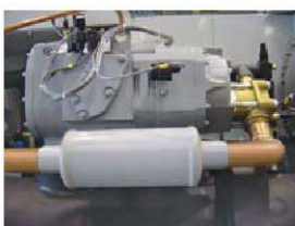
排气管路消音器
