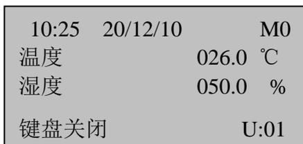
按【on/off】键开启网络中的所有机组，看是否有机组处于待机状态。按【on/off】键关闭其中某一台为开启状态的机组，看处于待机状态的机组是否会自动转为开启状态。然后重新开启刚才关闭的机组，看原来处于待机状态的机组是否返回待机状态。
