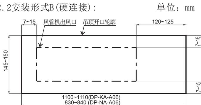
注意风管机与吊顶外壁距离要 $75\text{mm} \leq d \leq 80\text{mm}$ , 否则不利于面板安装(见下图)。
