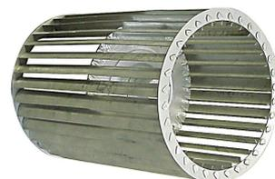
整片板材经冲压卷绕而成的风轮，为盘管提供均匀风速，提高了机组的送风量和换热效果。风机 100% 经过严格的动平衡调校，确保机组运转更加宁静、平稳。
