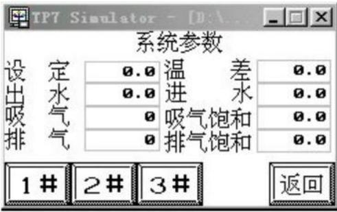
显示页提供对各个压力和温度变送器的实时测量值，以反映机组运行中的实际状态。
