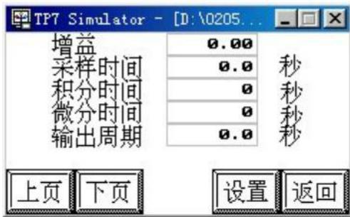
此页提供对机组能量控制的 PID 算法的参数进行设定（注意：当此页设置错误将导致 PID 算法溢出，或机组运行不正常，修改请慎重！）
