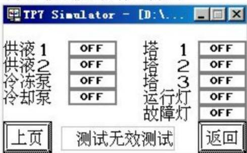
提供对供液电磁阀及冷冻泵、冷却泵及冷却却塔风扇的测试功能
