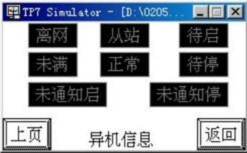
在使用两台机组且两台机组已正确连线，将正确显示另一机组在网络中的各种状况
