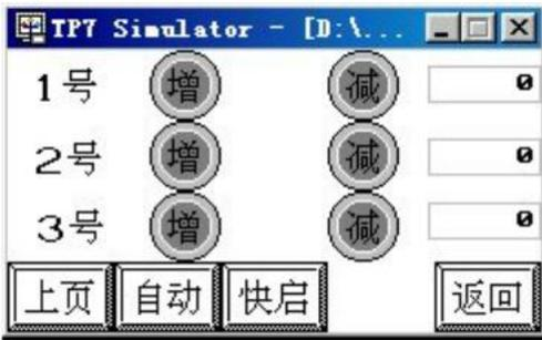
当需要手动调整能量时按下“自动”键，“自动”显示将变为“手动”此时能量的调节将由机组自动控制转为手动调节，用户可按下“增”或“减”键来调整压缩机能量，当无需手动调节时应将其设为“自动”。
