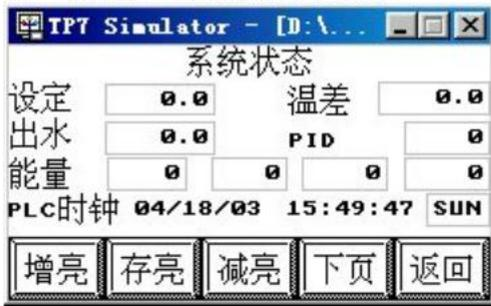
此页将显示出水温度及出水温度设定值，各压缩机的运行能量，当前温差显示蒸发器出水温度与设定温度的差值
