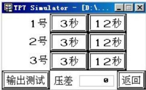
此页为机组测试页，提供机组运行前的测试，以检测压缩机旋向、压缩机有无异常噪声、星-三角形转换是否正常，高低压差显示为排气压力减去吸气压力的差值
