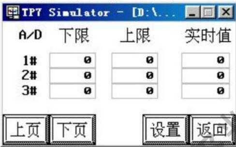
此页提供三台压缩机的能量校正功能，通过读取实时 A/D 值来校正 0%和 100%能量位
