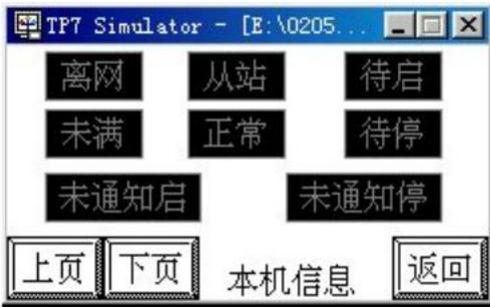
在使用两台机组且两台机组已正确连线，将正确显示本机在网络中的各种状况
