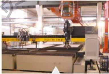
本设备工作台13x6.5米，安装两套火焰切割装置，一套精细等离子切割装置，对厚板用火焰切割，同样工件一次能完成两件，对薄板用精细等离子进行切割，切割速度每分钟12-15米，热变形小，切割精度高，精细等离子装置是目前世界较先进一种切割设备，并有开孔倒角、刻字、划线等功能。
