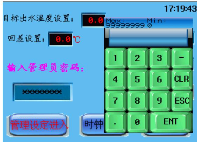
参数设定方法：在参数设定画面中：按需要设定的参数，即弹出小键盘，此时操作人员可轻触数字按键对参数进行设定。若参数输入有误，可用按键【CLR】清除参数。在此画面中【管理员设定】由海尔公司售后服务工程师进入。
