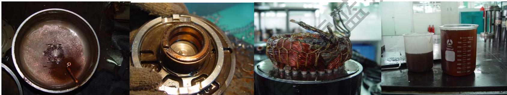
底部有大量铜屑， 轴套磨损严重， 部分线圈烧毁， 油量正常但有中度变质
