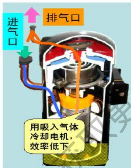
图1 典型的低压腔压缩机
