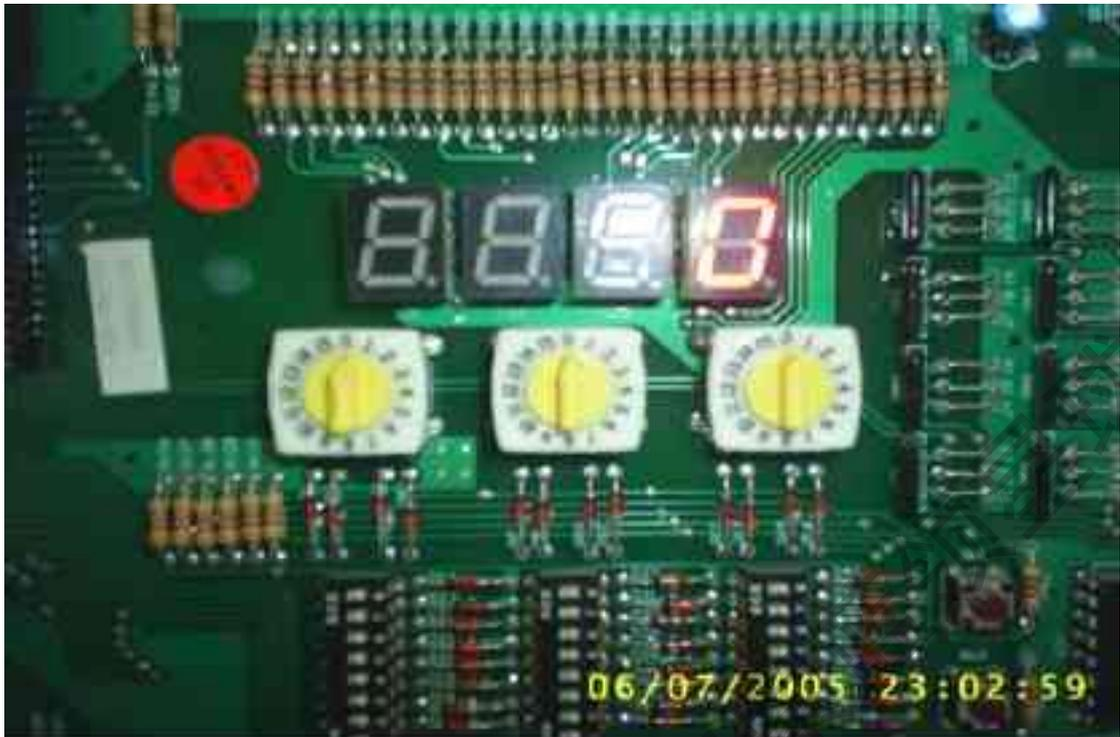
正常时：数码管显示为“0”，有故障时显示对应的故障代码。
