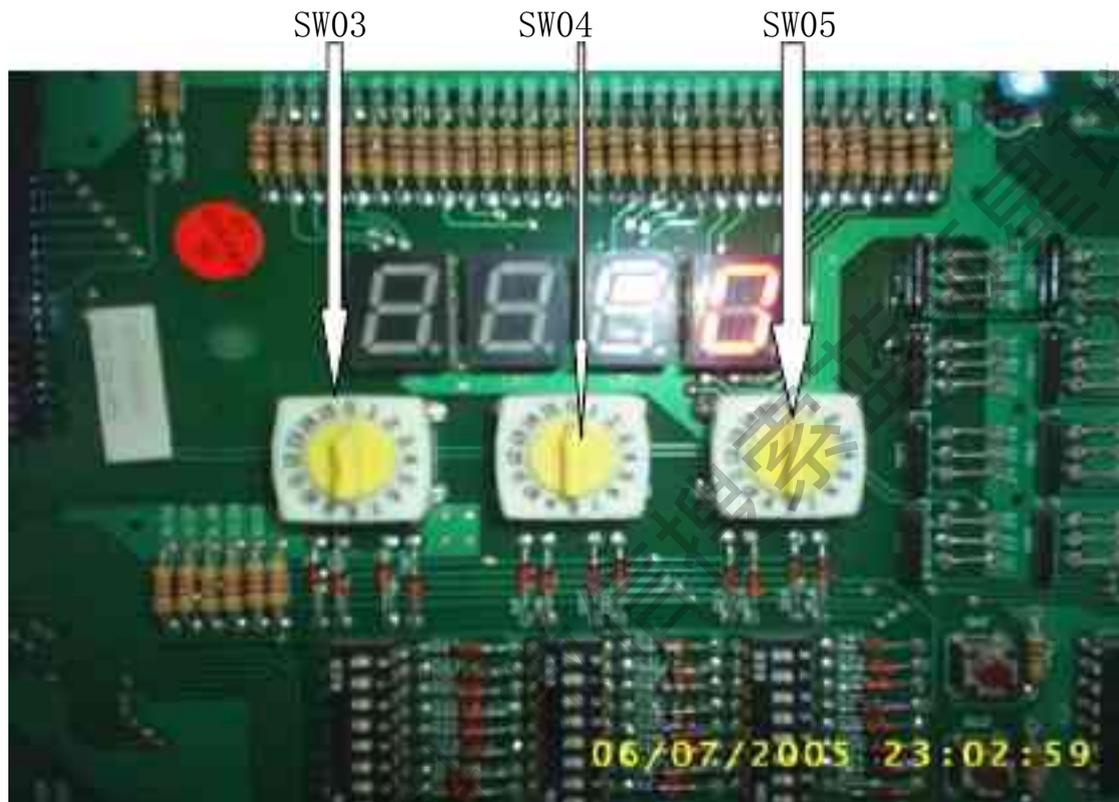
运转四十分钟以后，通过室外机数码管对室外机、室内机参数进行进行记录分析。具体操作如下所示：
